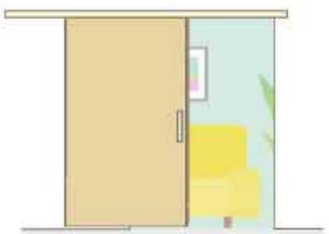
吊り戸のメリットは、床にレールの溝がなくフラットである、戸を引く音が響きにくい、比較的軽い力で開閉できるなどです。車椅子や掃除ロボットの通行がしやすく、ほりりがたまる溝がないため掃除がしやすいです。段差もなく転倒の心配もありません。
