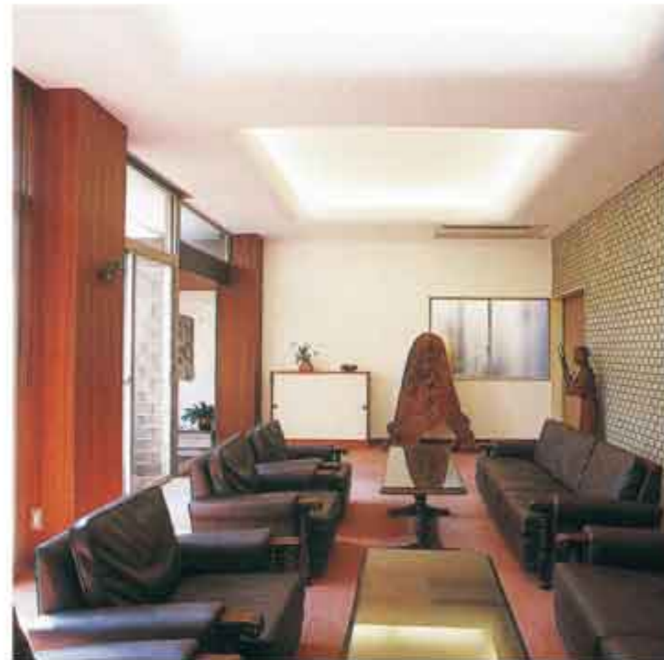
壁・天井の古くなったビニールをはがし、ウッドチップクロスを貼り、その上からドイツックイで仕上げました。
